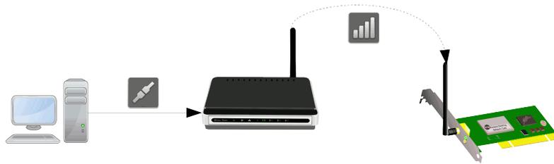
**Abbildung 3.2:** Direkte und ungestörte Messanordnung.
